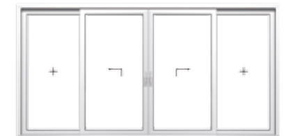
Schema C 2 Hebe-Schiebeflügel, 2 Festverglasungen
