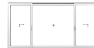
Schema K 2 Hebe-Schiebeflügel, 1 Festverglasung
