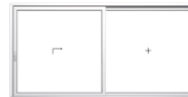
Schema A, DIN links 1 Hebe-Schiebeflügel, 1 Festverglasung
